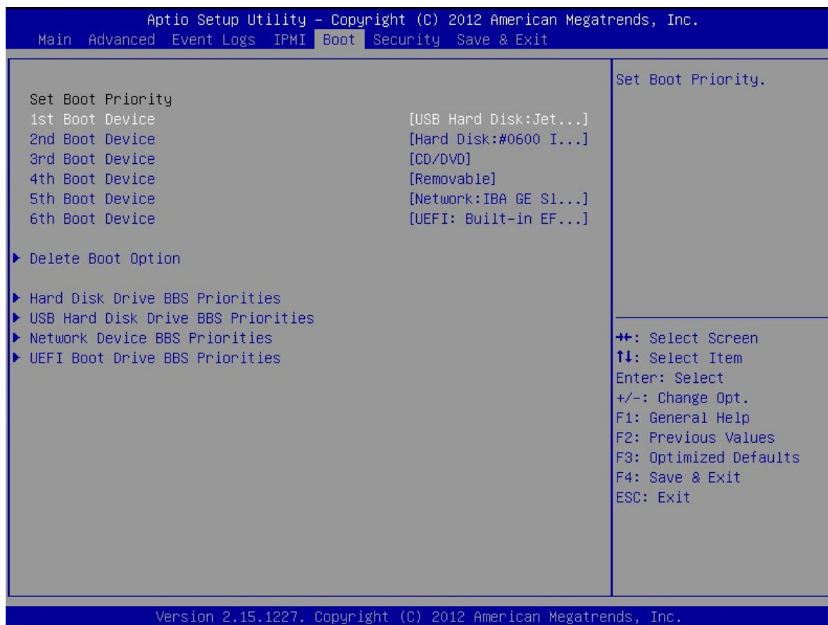
Рисунок 18 – Выбор в BIOS носителя, с которого будет выполняться установка RAIDIX 4.6
